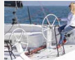
La doppia ruota è particolarmente comoda sia nella conduzione sia per garantire la migliore visibilità e per lasciare libero il passaggio centrale. L'opzione con la barra in vetroresina affascina chi ama il controllo preciso della pala del timone.
